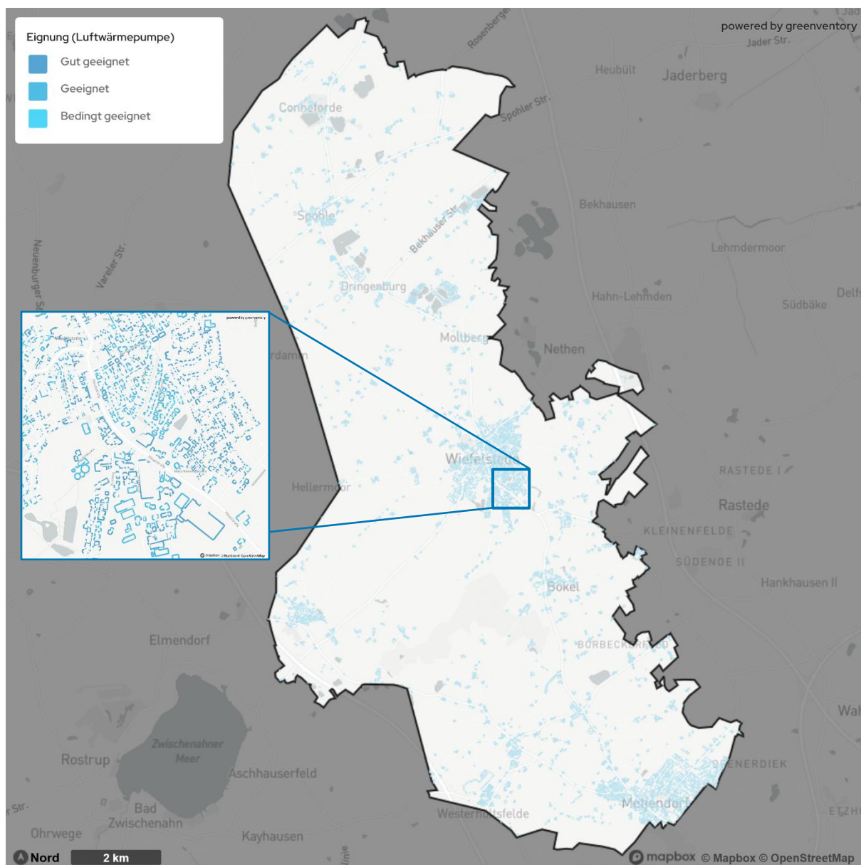
Abbildung 31: Potenziale von Luftwärmepumpen in der Gemeinde Wiefelstede
